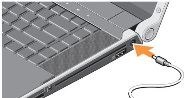
**⚠ ОСТОРОЖНО!** Адаптер переменного тока работает с электрическими розетками, используемыми во всем мире. Однако в разных странах используются разные разъемы электропитания и сетевые фильтры. Использование несовместимого кабеля, а также неправильное подключение
