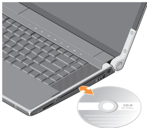
Чтобы извлечь диск из дисковода, слегка коснитесь значка извлечения ▲. Значок будет мигать несколько секунд в подтверждение принятой команды, после чего диск будет выгружен из слота.
