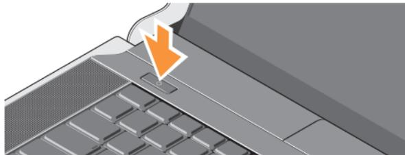
Чтобы включить компьютер, слегка нажмите кнопку питания
