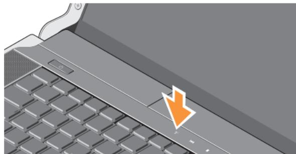
Эта кнопка позволяет быстро отключить все беспроводные радиоприборы (Bluetooth®, Wi-Fi и WWAN), например, если вас попросят отключить все беспроводные радиоприборы на борту самолета. При однократном нажатии на эту кнопку отключаются все радиоприборы. При повторном нажатии все радиоприборы приводятся в то состояние, в котором каждое из них находилось до первого нажатия этой кнопки.
