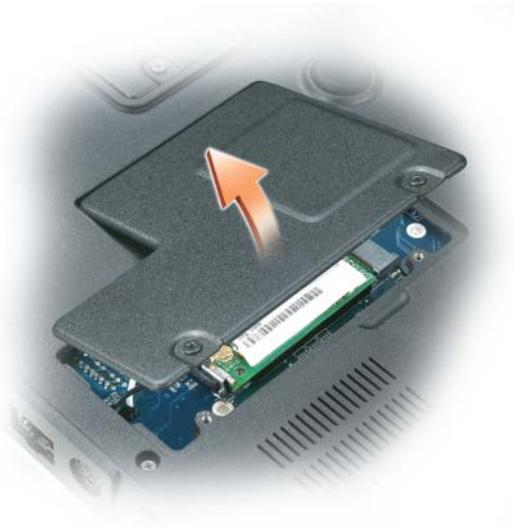
✏ **REMARQUE** : vous devez d'abord retirer les antennes de la carte Mini (reportez-vous à l'étape 3) pour pouvoir retirer l'ensemble de l'écran. Si une carte Mini est installée, déconnectez les câbles d'antenne de la carte. Si aucune carte Mini n'est installée, retirez les câbles d'antenne de leur emplacement.
