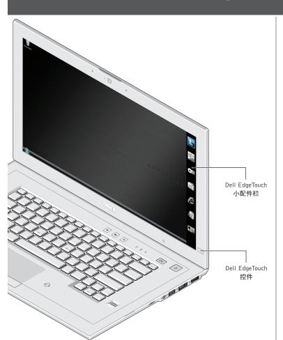
Dell EdgeTouch™ LCD 传感器是一项直观输入技术,通过安装在 Latitude Z 的右侧 LCD 框架下方的电容传感器阵列进行工作。使用这项技术,您可以通过可定制的小配件栏轻松体验一触式滚动功能和快速系统控制功能。
