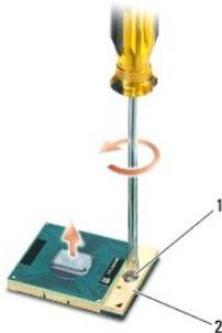
1 | vite della camma del connettore ZIF 2 | connettore ZIF
