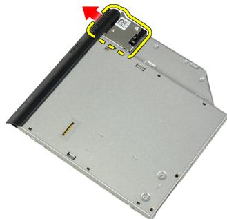
7. Uklonite vijke koji pričvršćuju nosač zasuna optičkog pogona na sklop optičkog pogona..
