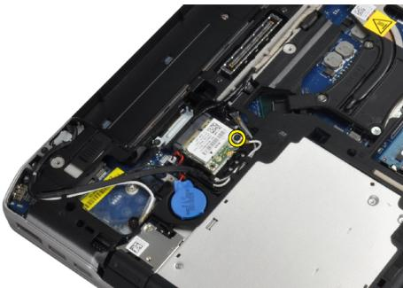
5. Uklonite WLAN karticu iz njezina utora na matičnoj ploči.
