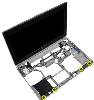
4. Uklonite kabel zvučnika iz kanala za usmjeravanje.
