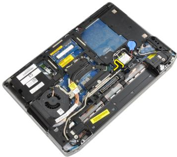
7. Uklonite kabel LVDS-a i kamere iz kanala za usmjerenje.
