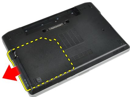
5. Uklonite vijak koji pričvršćuje zasun optičkog pogona na sklop optičkog pogona.
