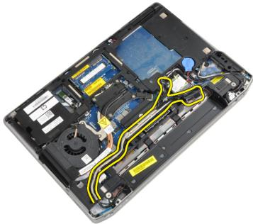
8. Odspojite sve antene spojene na rješenja za bežično povezivanje.
