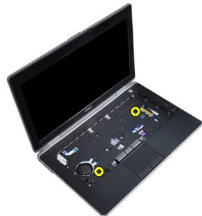
5. Odspojite LED kabel s matične ploče.
