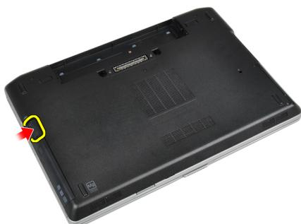
4. Izvucite optički pogon iz računala.
