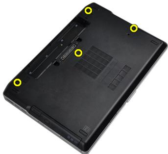
3. Podignite poklopac kućišta i uklonite ga s računala.
