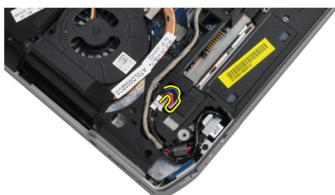
4. Uklonite vijak koji pričvršćuje nosač priključka napajanja na računalo.
