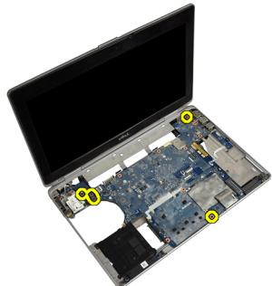
11. Polako podignite lijevi rub sklopa matične ploče pod kutom od 45 stupnjeva i oslobođite matičnu ploču od priključaka zdesna.
