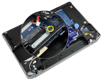
6. Uklonite nosač kabela LVDS-a iz računala.
