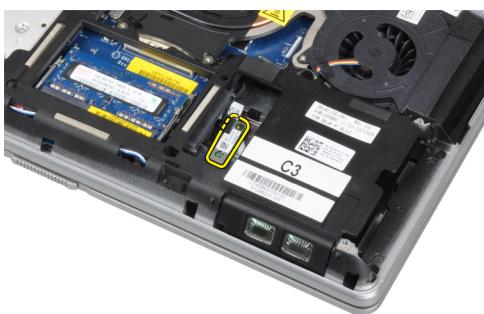
5. Odspojite Bluetooth kabel s matične ploče i uklonite karticu iz računala.
