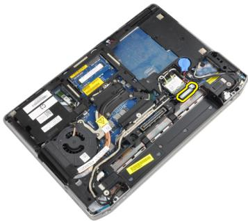
5. Povucite jezičac prema gore i odspojite kabel LVDS-a s računala.
