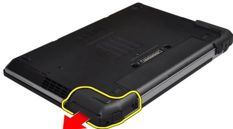
4. Za uklanjanje lijevog poklopca priključaka ATG-a ponovite korake 1 i 2.
