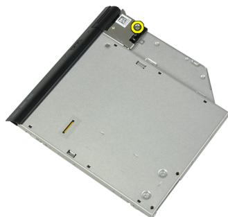
6. Gurnite zasun optičkog pogona prema naprijed i uklonite ga sa sklopa optičkog pogona.
