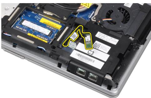
6. Odspojite kabel s Bluetooth kartice.
