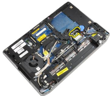
9. Uklonite sve antene iz kanala za usmjeravanje.
