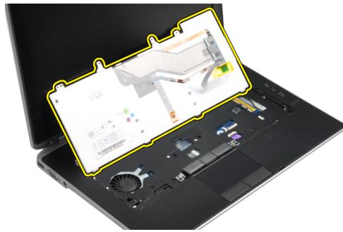
8. Odlijepite ljepljivu traku koja pričvršćuje priključak tipkovnice.
