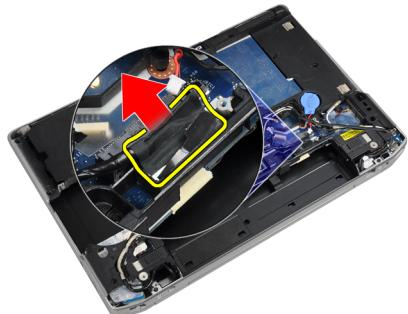
8. Odspojite kabel zvučnika s baze matične ploče.
