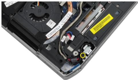
5. Uklonite nosač priključka napajanja s računala.
