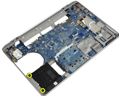
4. Podignite potpornu ploču tvrdog pogona iz računala.
