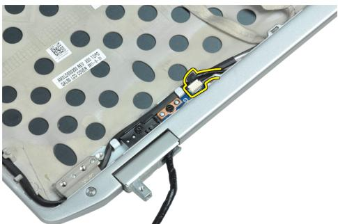
4. Uklonite vijak koji pričvršćuje ploču snažnog LED-a na sklop zaslona.
