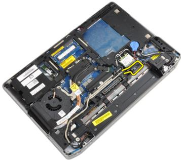
6. Iskopčajte kabel kamere iz računala.
