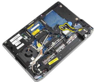
10. Uklonite vijke koji pričvršćuju sklop zaslona na računalo.
