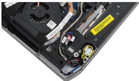
6. Uklonite kabel priključka napajanja s računala.
