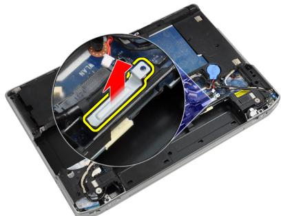
7. Odspojite kabel LVDS-a s poledine matične ploče.
