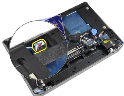
9. Preokrenite sustav i odspojite kabel medijske ploče s baze matične ploče.
