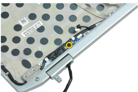
5. Uklonite ploču snažnog LED-a sa sklopa zaslona.
