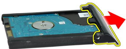
7. Uklonite izolaciju tvrdog pogona s tvrdog pogona.
