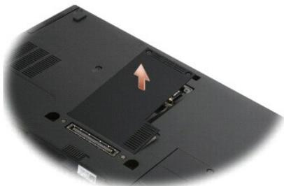
➡ **AVVISO:** per evitare danni al connettore del modulo di memoria, non usare attrezzi per rimuovere o ricollocare il modulo stesso.
