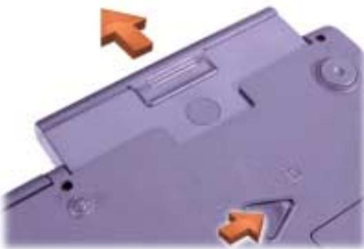
**6** Faites glisser fermement la nouvelle batterie dans la baie de batterie. Vous devez entendre un clic indiquant que la batterie est correctement installée.
