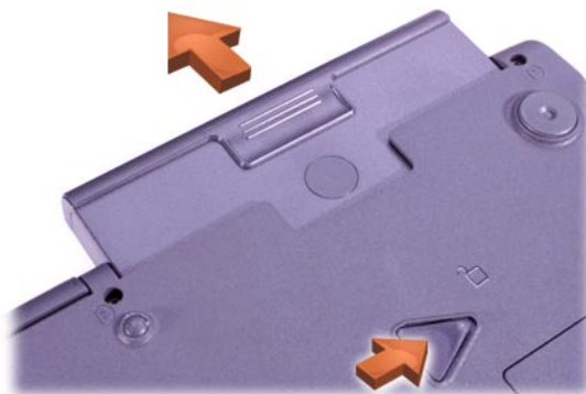
图 2-8：从电池槽中取出电池
