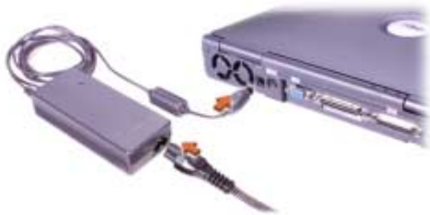
Figura 6-2. Ligar o transformador de CA
