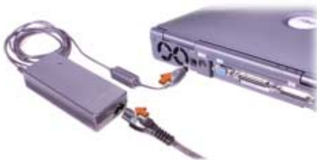
Figura 4-2. Conexión del adaptador de CA
