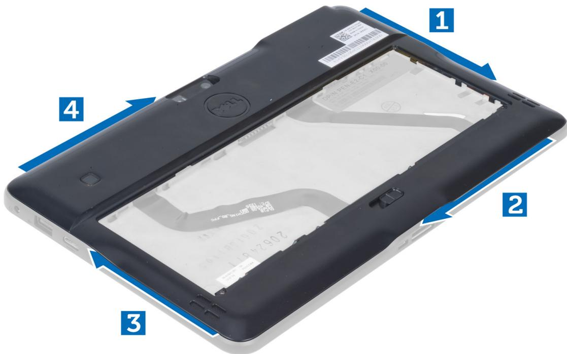
5. Levante as patilhas que fixam a tampa da base na área do compartimento da bateria na direcção vertical. Levante a tampa da base.
