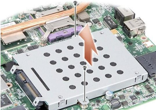
4. 按住硬盘驱动器部件的连接端，从系统板连接器中拉出硬盘驱动器部件。
