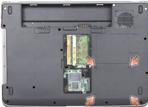
13. 拧下将系统板固定到计算机底座的其余两颗螺钉。
