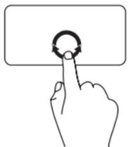
Mova o dedo na área de deslocamento horizontal (extremidade inferior do touch pad) em um movimento circular no sentido horário para deslocar para a direita ou no sentido inverso ao dos ponteiros do relógio para rolar para a esquerda.
