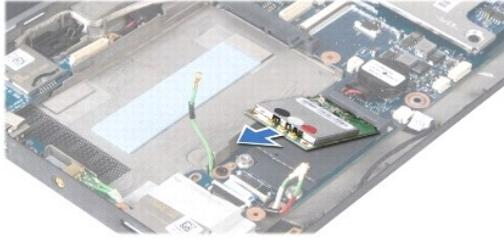
11. Rimuovere la vite che fissa la scheda del connettore di sintonizzazione TV.
