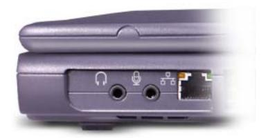
**СОВЕТ**: Сетевой разъём немного больше по размеру, чем разъём модема. Не подключайте телефонную линию к сетевому разъему.
