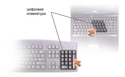
Цифровая клавиатура функционирует так же, как цифровая клавиатура на внешней клавиатуре. Каждая клавиша на клавиатуре имеет несколько функций. Цифры и символы на клавиатуре отмечены синим цветом справа от клавиш клавиатуры.
