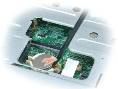
Quando si reinserte la batteria, inserirla con un'inclinazione di 30 gradi sotto il fermaglio con il lato positivo (contraddistinto da un segno più [+]) rivolto verso l'alto, quindi spingerla in posizione.
