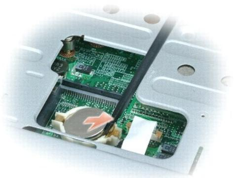
Wenn Sie die Batterie ersetzen, schieben Sie diese in einem 30°-Winkel mit dem Pluspol (erkennbar am Plus [+] Zeichen) nach oben unter die Klammer, und drücken Sie sie dann in die korrekte Position.
