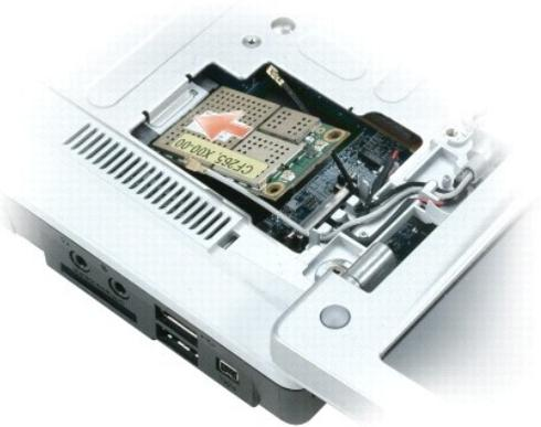
➡ **HINWEIS:** Um eine Beschädigung der Mini-Card zu vermeiden, sollten Sie das Kabel nie unter der Karte platzieren.
