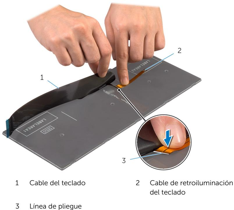
3 Usando de la línea de alineación, doble con cuidado el cable del teclado.
