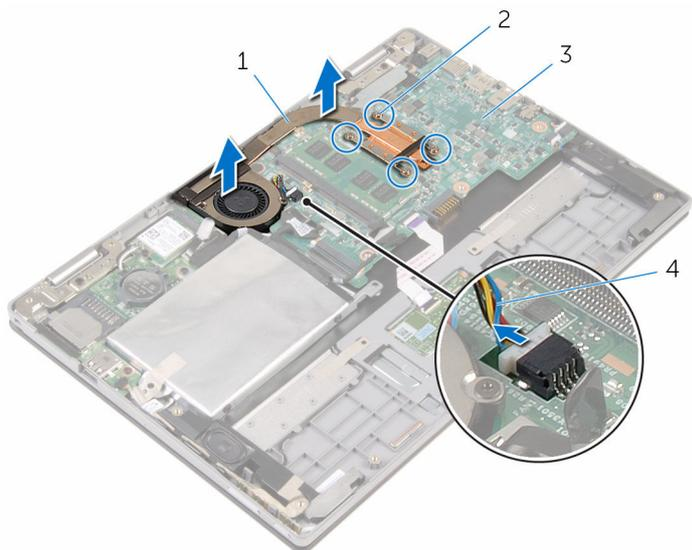
1 bloc ventilateur-dissipateur thermique du processeur
