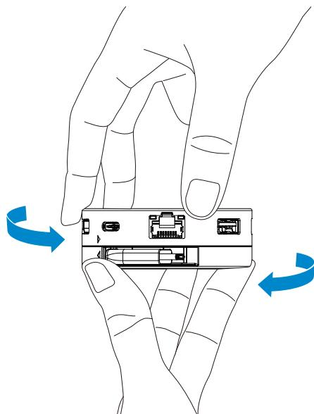
2. Повернув кабель USB-C к себе, поверните верхнюю часть, чтобы отсоединить кабель USB-C.
