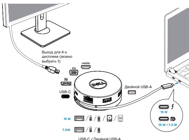
4. DA310 поддерживает сквозное питание мощностью до 90 Вт при подключении к порту Thunderbolt или USB-C (альтернативный режим (DisplayPort) вашего ПК. Питание может подаваться от адаптера питания USB-C или монитора USB-C с возможностью подачи питания, поддерживающей функцию зарядки. На следующих двух изображениях показан DA310, подключенный к внешнему источнику питания через адаптер питания USB-C или монитор USB-C.
