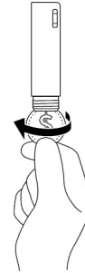
Figura 3. Imagem: Como remover o suporte da bateria de célula tipo moeda com uma ferramenta.
