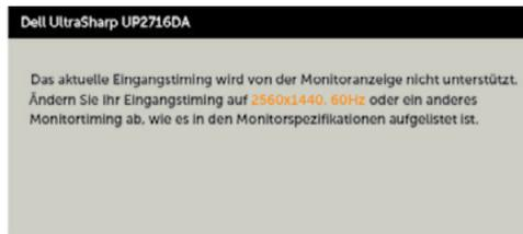
Das bedeutet, dass sich der Monitor mit dem vom Computer empfangenen Signal nicht synchronisieren kann. Siehe [Technische Daten des Monitors](#) für die horizontalen und vertikalen Frequenzbereiche, die für diesen Monitor adressierbar sind. Empfohlener Modus ist 2560 x 1440.
