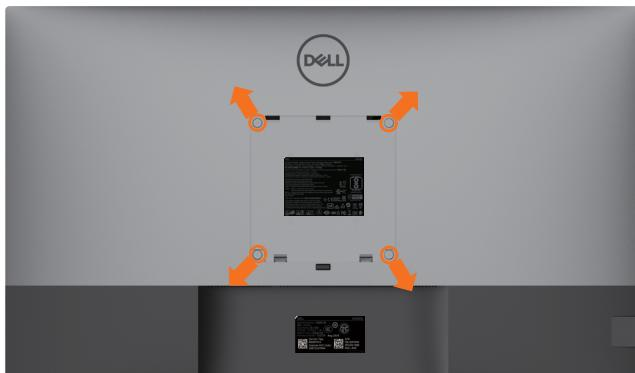
**NAPOMENA:** Koristite vijke M6 x 12 mm (200 mm x 200 mm) ili M4 x 12 mm (100 mm x 100 mm) da biste povezali monitor na komplet za montiranje na zid.
