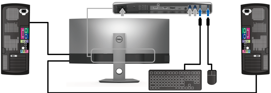
b. Conexión de dos ordenadores
