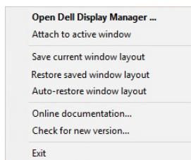
За да се върнете на предпочтитано оформление, първо "**Save current window layout**" (**Запис на оформление на текущия прозорец**) и после "**Restore saved window layout**" (**Възстановяване на оформление на записан прозорец**).
