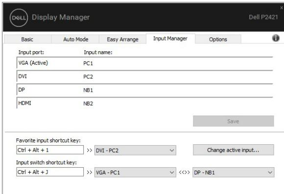
Можете да използвате падащото меню за превключване към произволен източник на входен сигнал.
