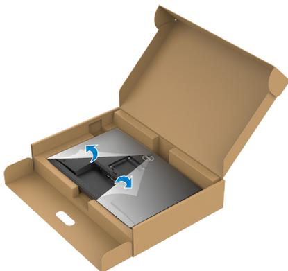
**5.** Deslize as abas na base do suporte para as aberturas da parte de baixo do monitor e pressione o suporte para encaixá-lo.
