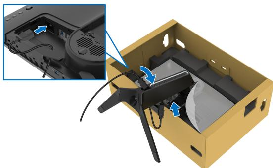
9. スタンドのケーブル管理スロットに USB アップストリームケーブル、USB ダウンストリームケーブル（別売り、ケーブル類は含まれません）、HDMI ケーブル、DisplayPort ケーブルなどの必要なケーブルを通します。
