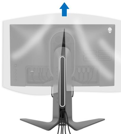
13. I/O カバーのタブがディスプレイバックカバーのスロットにしっかりと収まるようにスライドさせます。
