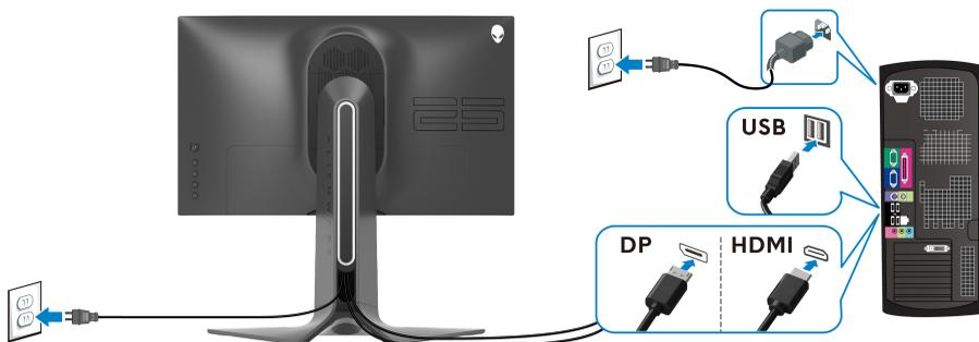
1. DisplayPort ケーブルまたは HDMI ケーブルのもう片端をコンピューターに接続します。
