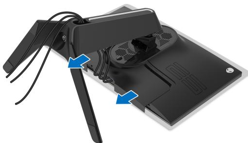
5. ケーブルをモニターから外し、スタンドライザーのケーブル整理用スロットから外します。
