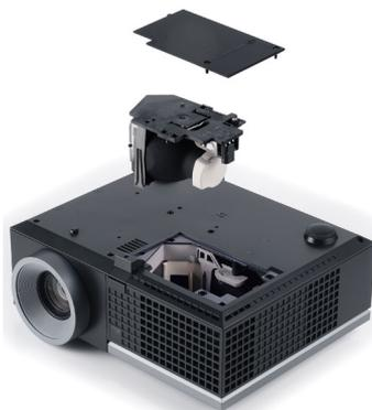
9 Azzerare il tempo di funzionamento della lampada selezionando "Sì" per **Ripristino lamp.** nella scheda **Lampada** dell'OSD (vedere il menu **Lampada** a pagina 40). Quando si sostituisce un nuovo modulo lampada, il proiettore lo rileva automaticamente e azzerà le ore della lampada.
