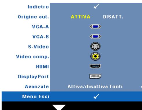
**ORIGINE AUT.**—Selezionare **Disatt.** (opzione predefinita) per bloccare il segnale di ingresso corrente. Se si preme il tasto **Sorgente** quando si imposta la modalità **Origine aut.** su **Disatt.**, è possibile selezionare manualmente il segnale di ingresso. Selezionare **Attiva** per rilevare automaticamente i segnali di ingresso disponibili. Se viene premuto il tasto **Sorgente** quando il proiettore è acceso, ricercherà automaticamente il
