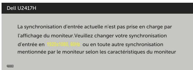
Cela signifie que l'écran ne peut pas se synchroniser avec le signal reçu depuis l'ordinateur. Voir [Spécifications du moniteur](#) pour connaître les limites des fréquences Horizontales et Verticales acceptables par ce moniteur. Le mode recommandé est 1920 X 1080.
