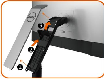
1. Retirez le couvercle du bras qui est fixé avec des aimants à l'élément de surélévation du bras.
