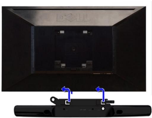
1. Встав позади монитора, прикрепите звуковую панель Soundbar, совместив два паза с двумя выступами вдоль нижнего края монитора.
