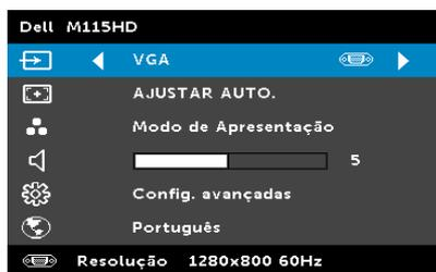
**DET AUT ORIGEM**—Se seleccionar e premir  $\checkmark$  para activar, a opção Det aut origem procura automaticamente a próxima origem de entrada de sinal disponível.
