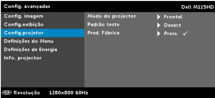
**MODO DO PROJECTOR**—Permite-lhe seleccionar o modo do projector, consoante a forma como o projector estiver montado.
