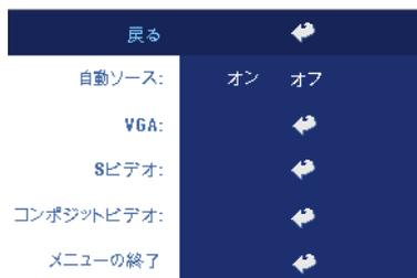
**自動ソース**—オン (既定値) を選択すると、使用可能な入力信号を自動検出します。プロジェクタの電源が入った状態で **SOURCE (ソース)** ボタンを押すと、自動的に次の入力信号を検出します。**オフ** を選択すると、現在の入力信号をロックします。**オフ** が選択された状態で **SOURCE (ソース)** を押すと、使用したい入力信号を自分で選択することができます。
