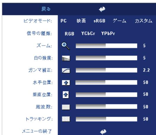
**ビデオモード**—プロジェクタの使用方法に基づきディスプレイを最適化するために、**PC**、**ムービー**、**sRGB** (より正確な色表現が可能)、**ゲーム**、**カスタム** (好みの設定に設定) から選択します。**白の強度**または**ガンマ補正**を調整する場合、プロジェクタは自動的に**カスタム**に切り替わります。
