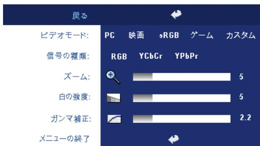
ビデオモード —プロジェクタの使用方法に基づきディスプレイを最適化するために、PC、ムービー、sRGB (より正確な色表現が可能)、ゲーム、カスタム (好みの設定に設定) から選択します。白の強度またはガンマ補正を調整する場合、プロジェクタは自動的にカスタムに
