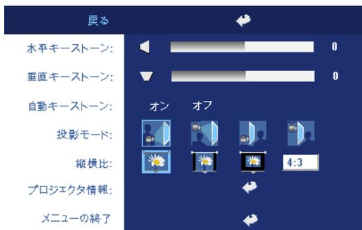
**垂直キーストーン**—プロジェクタの傾きによって起こるゆがみを調整します。
