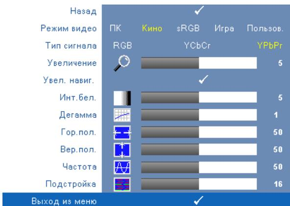
**Режим видео**—Оптимизация режима отображения проектора.
