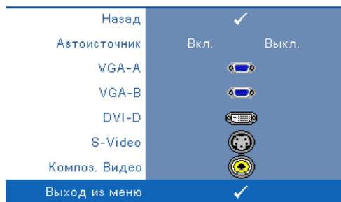
**Автоисточник**—Для автоматического определения доступных источников сигнала выберите «Вкл.» (используется по умолчанию). Нажатие кнопки «Источник» при включенном проекторе позволяет выполнить автоматический поиск следующего доступного входного сигнала. Чтобы заблокировать текущий
