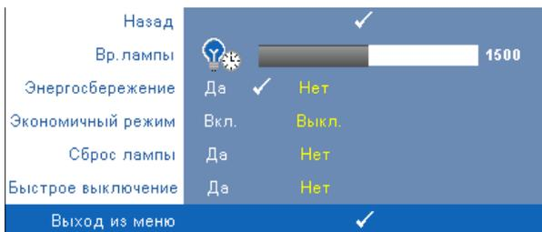
**Вр. лампы**—Отображение времени работы лампы в часах с момента последнего сброса.
