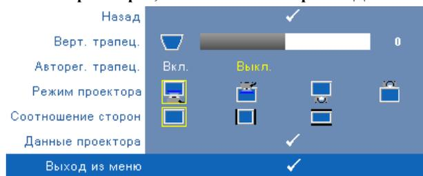
**Верт. трапец.**—Регулировка искажения изображения, вызванного наклоном проектора.
