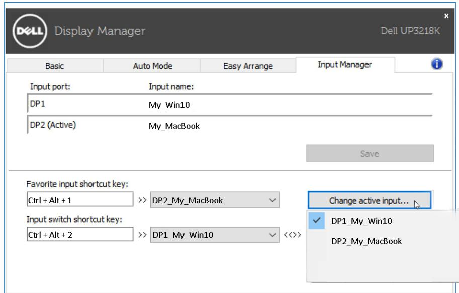
**참고:** DDM은 모니터가 다른 컴퓨터에서 가져온 비디오를 표시하고 있더라도 사용자의 모니터와 통신을 주고받습니다. DDM을 자주 사용하는 PC에 설치한 다음 해당 기기에서 전환하여 입력을 제어할 수 있습니다. 또한 모니터에 연결된 다른 여러 대의 PC에도 DDM을 설치할 수 있습니다.
