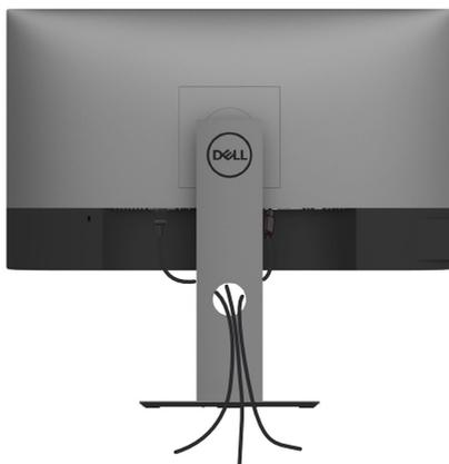
След прикрепване на всички необходими кабели към монитора и компютъра (вижте [Свързване на Вашия монитор](#) за прикрепване на кабелите) организирайте всички кабели, както е показано по-горе.
