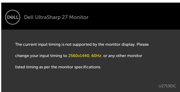
Това означава, че мониторът не може да се синхронизира със сигнала, който получава от компютъра. Вижте [Технически характеристики на монитора](#) относно диапазона на хоризонтална и вертикална честота, които са адресирани за този монитор. Препоръчителният режим е 1920 x 1080 (U2419HC)/2560 x 1440 (U2719DC). Ще видите следното съобщение преди да бъде забранена функцията DDC/CI.
