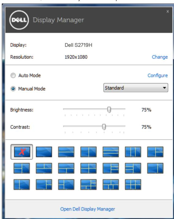
A caixa de diálogo Configurações rápidas também fornece acesso ao Dell Display Manager, interface de usuário avançada que é utilizada para ajustar as funções básicas, configurar modo automático e acesso a outros recursos.
