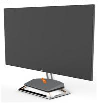
**5** スピーカーがスタンドベースに完全に挿入され、安定して取り付けられていることを確認します。
