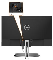
7 スピーカーケーブルに接続されたケーブルホルダーをスタンドスロットに挿入します。 .それに応じてスロットに沿ってケーブルホルダーの位置を調整します。
