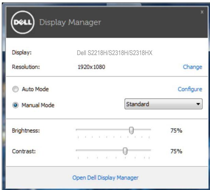
Диалоговое окно **Quick Settings (быстрой настройки)** также обеспечивает доступ к расширенному пользовательскому интерфейсу Dell Display Manager, который используется для регулировки основных функций, настройки автоматического режима и доступа к другим функциям.
