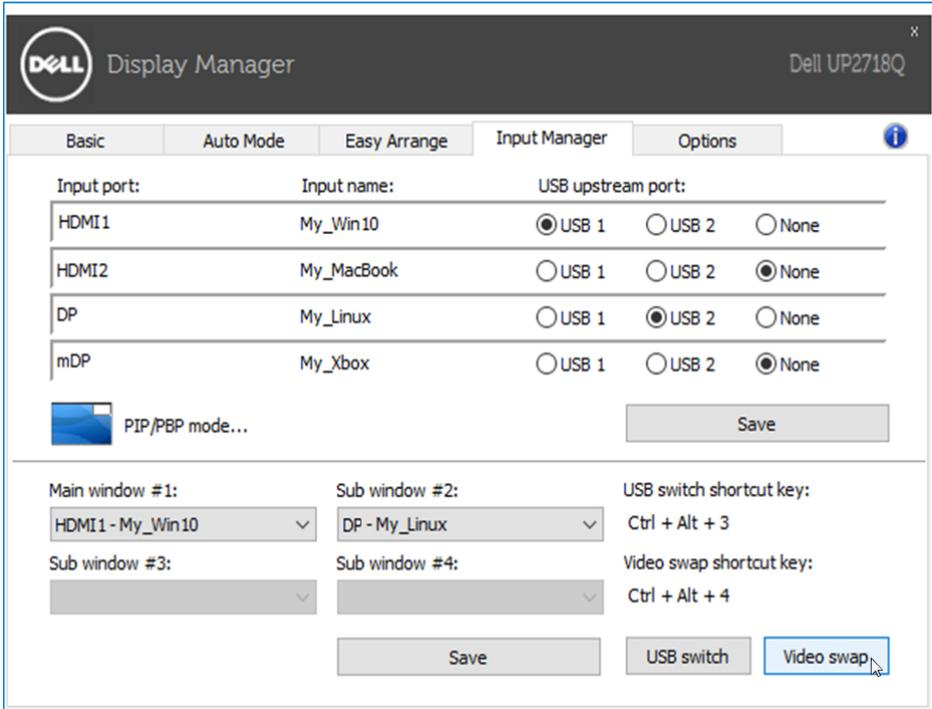
Bạn có thể gán một cổng ngược dòng USB với đầu vào video. Cổng ngược dòng USB vừa gán sẽ được kết nối với máy tính khi video từ cổng đó đang hiển thị trên màn hình.
