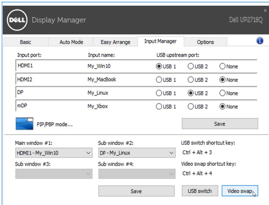
С помощью входного видеосигнала можно USB-порт передачи. Назначенный USB-порт передачи будет подключаться к компьютеру, когда на мониторе воспроизводится его видеосигнал.
