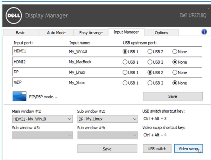
Можете да зададете USB upstream порт с входен видеосигнал. Назначеният USB upstream порт ще бъде свързан към компютъра, когато на монитора се показва видео.
