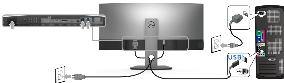
a. Pripojenie jedného počítača
