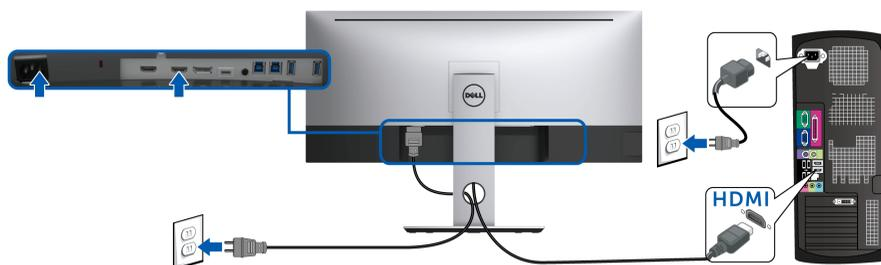
**📎 注：** 工場出荷時には、U3419W は HDMI 2.0 に設定されています。HDMI ケーブルを接続してもモニターに何も表示されない場合は、次の手順にしたがって設定を HDMI 2.0 から HDMI 1.4 に変更してください：
