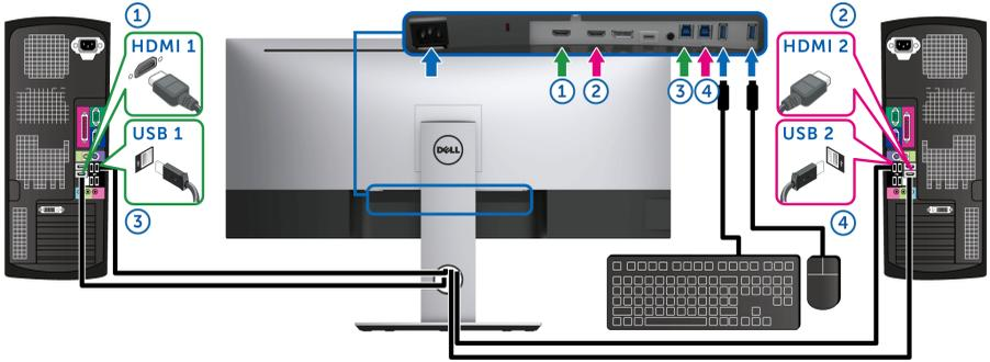
HDMI 1 の USB 選択が USB 1 に設定してあり、HDMI 2 が USB 2 に設定されていることを確認してください。
