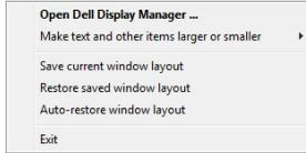
Uygulama pencerelerini taşıdıktan sonra favori düzenine geri dönmek isterseniz, önce **"Save current window layout" (Mevcut pencere düzenini kaydet)** ve daha sonra **"Restore saved window layout" (Kaydedilen pencere düzenini geri yükle)** işlemini yapabilirsiniz.
