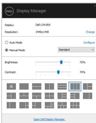
A caixa de diálogo **Configurações rápidas** também fornece acesso à interface avançada do usuário do Dell Display Manager, que é usada para ajustar as funções básicas, configurar o modo automático e acessar outros recursos.
