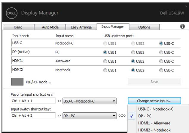
**NOTA:** O DDM se comunica com seu monitor mesmo quando ele está exibindo vídeo de outro computador. Você pode instalar o DDM no computador que você usa frequentemente e controlar a mudança de entrada através dele. Você também pode instalar o DDM em outros computadores conectados ao monitor.
