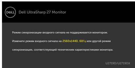
Это означает, что монитор не может произвести синхронизацию с получаемым от компьютера сигналом. Информацию о диапазонах частоты строк и кадров, применимых к данному монитору, см. в разделе [Технические характеристики монитора](#). Рекомендуется разрешение 1920 x 1080 (U2419H/U2419HX)/2560 x 1440 (U2719D/U2719DX).
