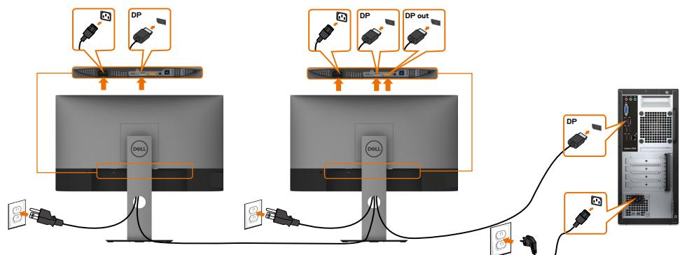
**ПРИМЕЧАНИЕ.** Монитор поддерживает функцию DP MST. Для использования этой функции видеокарта компьютера должна соответствовать спецификации DP1.2 и поддерживать режим MST.
