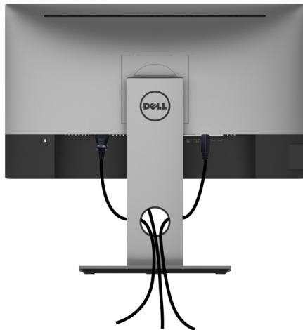
След прикрепване на всички необходими кабели към монитора и компютъра (вижте [Свързване на Вашия монитор](#) за прикрепване на кабелите) организирайте всички кабели, както е показано по-горе.
