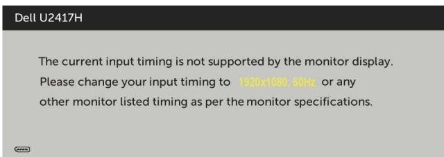
Това означава, че мониторът не може да се синхронизира със сигнала, който получава от компютъра. Вижте [Технически характеристики на монитора](#) относно диапазона на хоризонтална и вертикална честота, които са адресириани за този монитор. Препоръчителният режим е 1920 x 1080.
