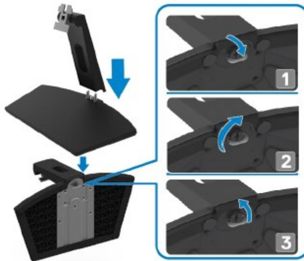
2. 將立架對準顯示器背面的溝槽。
