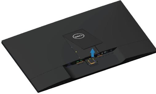
4. 使用螺絲起子拆下固定塑膠護蓋的四顆螺絲。
