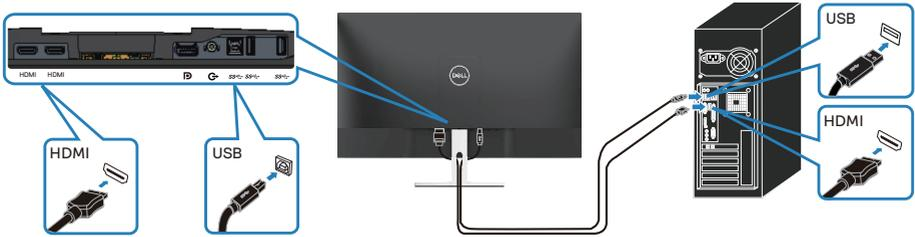
1. 將上游 USB 3.0 連接埠（顯示器隨附連接線）接至電腦上合適的 USB 3.0 連接埠。（請參閱**無顯示器立座的底部圖**瞭解詳情。）
