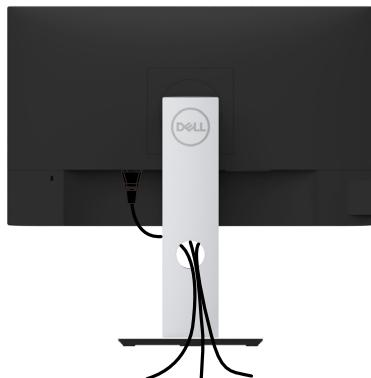
След прикрепване на всички необходими кабели към монитора и компютъра (вижте [Свързване на Вашия монитор](#) за прикрепване на кабелите) организирайте всички кабели, както е показано по-горе.
