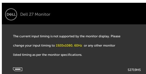
Това означава, че мониторът не може да се синхронизира със сигнала, който получава от компютъра. Вижте [Технически характеристики на монитора](#) относно диапазона на хоризонтална и вертикална честота, които са адресирани за този монитор. Препоръчителният режим е 1920 x 1080.
